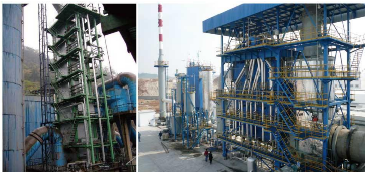
Котел-утилизатор печей для обжига Группа компаний «ЛунЛинь», пров. Фуцзянь
