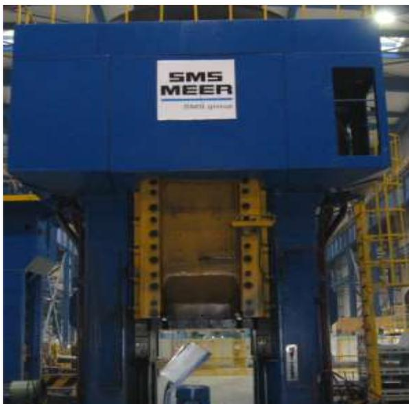
HSPZ630 - 8000 т. винтовой пресс с гидроприводом
